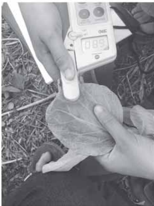
ภาพที่ 3 เครื่องวัดความเขียวใบ
